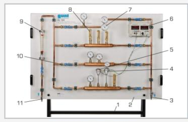
1 bastidor, 2 panel, 3 grifo de escape, 4 termoelemento tipo K, 5 temómetro de resistencia tipo Pt100, 6 indicadores digitales para Pt100 y termopar tipo K, 7 termómetro cuadrante bimetálico, 8 termómetro de dilatación de líquido, 9 rotámetro, 10 grifo de bola, 11 toma de agua
