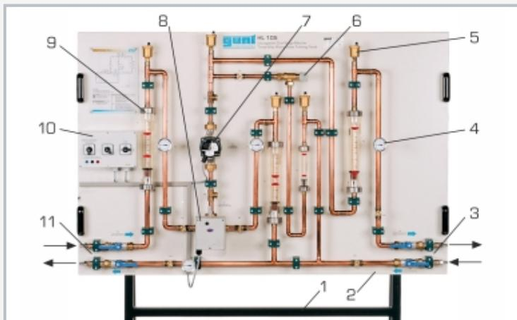
1 bastidor, 2 panel, 3 toma de agua de calefacción, 4 termómetro bimetalico, 5 purgador de aire, 6 válvula de rebose de presión diferencial, 7 bomba, 8 válvula mezcladora de 3 vías con servomotor, 9 rotámetro, 10 armario de distribución control de la válvula mezcladora, 11 tomas de agua de caldera
