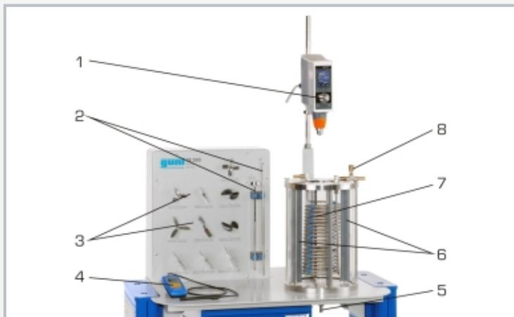
1 mecanismo de agitación con indicación del número de revoluciones y del par, 2 agitador de turbina y eje roscado para elementos de agitación, 3 elementos de agitación, 4 medidor de conductividad, 5 salida, 6 placa deflectora, 7 serpentín, 8 válvula de cierre para el serpentín
