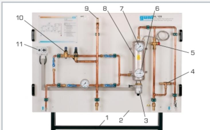
1 bastidor, 2 panel, 3 dispositivo de calefacción, 4 válvula de sobrepresión, 5 válvula de seguridad térmica, 6 manómetro de Bourdon, 7 termómetro bimetalico, 8 depósito a presión, 9 válvula de seguridad, 10 grupo de seguridad, 11 armario de distribución para el dispositivo de calefacción
