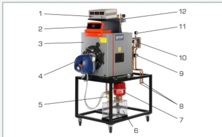
1 amplificador de medida con indicadores digitales, 2 unidad reguladora de caldera, 3 caldera de calefacción con mirilla, 4 termoelemento, 5 filtro de fuel de dos pasos, 6 depósito del fuel, 7 vaso de expansión, 8 tomas del circuito de agua fría, 9 contador de agua, 10 cambiador de calor, 11 termómetro, 12 grupo de seguridad
