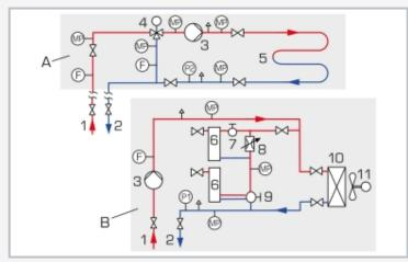
1, 2 conexiones para la unidad de suministro (p.ej. HL 353), 3 bomba, 4 mezclador de tres vías, 5 calefacción de suelo, 6 radiador, 7 válvula termostática, 8 válvula de estrangulación, 9 válvula de radiador monotubo, 10 calentador de aire, 11 soplante;
