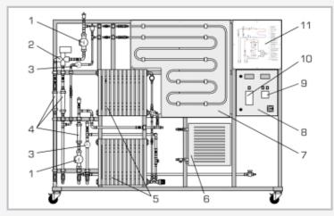
1 bomba de circulación, 2 mezclador de tres vías, 3 manómetro, 4 caudalímetro, 5 radiador, 6 calentador de aire con soplante, 7 calefacción de suelo, 8 armario de distribución con elementos de indicación y mando, 9 regulador de temperatura ambiente, 10 regulador de calefacción en función de la temperatura, 11 esquema de proceso
