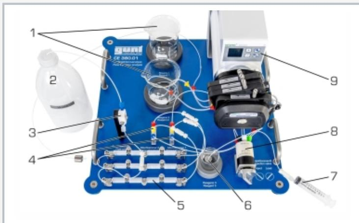
1 depósitos para reactivo 1 y 2, 2 desecho, 3 célula de caudal, 4 cámaras de mezclas, 5 circuito de reacción, 6 reactivo 3 GOx, 7 jeringa de inyección, 8 válvula de inyección, 9 bomba peristáltica multicanal
