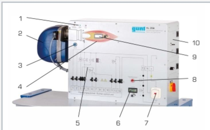
1 elementos de indicación, 2 quemador de gas de tiro forzado, 3 pulsador "reset", 4 imitación de la llama, 5 esquema de circuitos, 6 indicación de temperatura de termostato, 7 interruptor de emergencia de la instalación de calefacción, 8 pulsador "reset" de limitador de temperatura, 9 indicación de temperatura de agua de caldera, 10 palpadores de fallos
