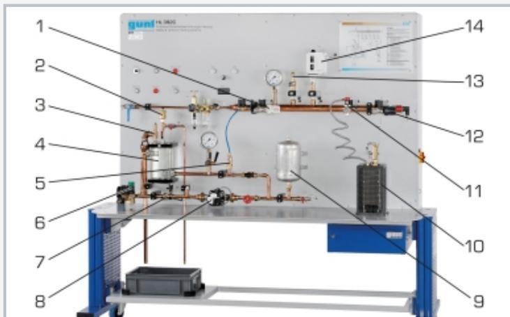
1 válvula termostática, 2 válvula de aireación rápida, 3 válvula de seguridad, 4 separador de aire, 5 válvula de retención, 6 válvula de desahogo de presión, 7 conmutador de flujo, 8 bomba, 9 vaso de expansión, 10 dispositivo de calefacción, 11 válvula de seguridad térmica, 12 regulador de temperatura, 13 válvula de seguridad, 14 limitador de presión de seguridad
