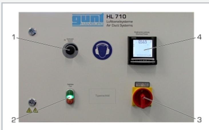
1 ajuste número de revoluciones del soplante, 2 interruptor de encendido/apagado soplante, 3 interruptor principal, 6 medidor de potencia
