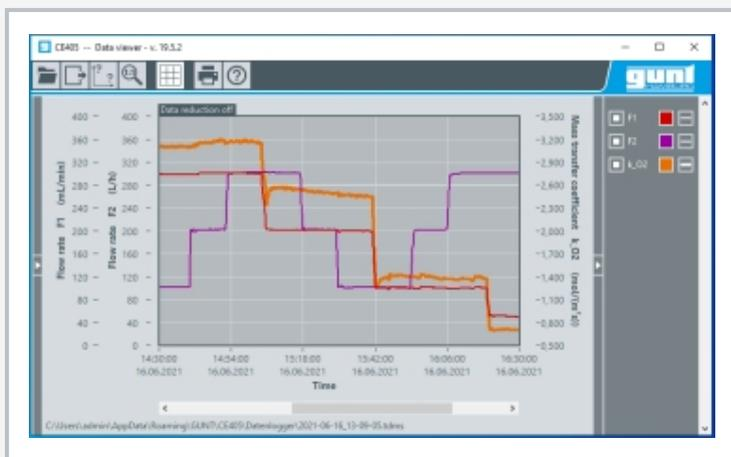
Captura de pantalla del software: curva de tiempo del coeficiente de transferencia de masa con el caudal de agua y aire
