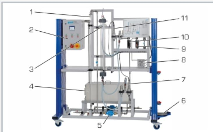
1 columna de desorción, 2 armario de distribución, 3 columna de absorción, 4 depósito, 5 bomba, 6 soporte para cilindro de gas presurizado, 7 sensores de oxígeno y temperatura después de la absorción, 8 compresor, 9 caudalímetro (aire), 10 caudalímetro (agua), 11 sensores de oxígeno y temperatura antes de la absorción
