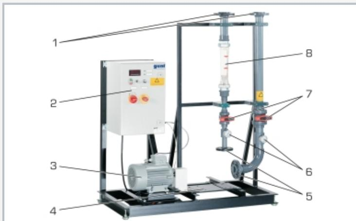
1 conexiones de brida para unir HL 962 a HL 962.30, 2 caja de distribución con elementos de indicación y mando, 3 motor eléctrico, 4 placa para montaje de la bomba de ensayo, 5 conexiones de brida para bomba de ensayo, 6 manómetro, 7 válvula, 8 caudalímetro
