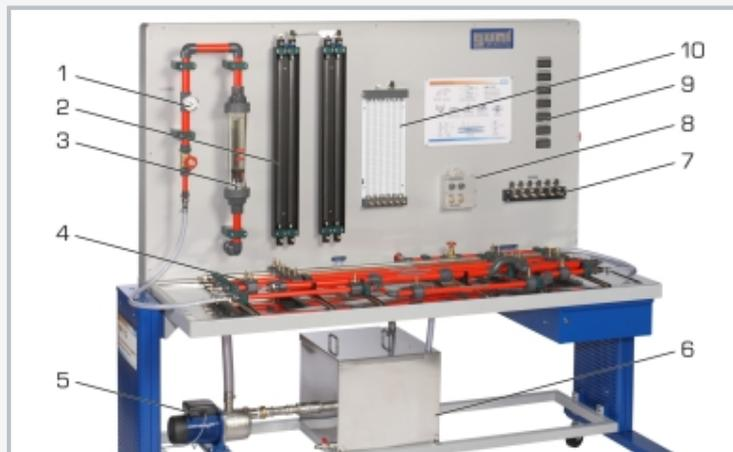
1 termómetro, 2 dos tubos manométricos, 3 rotámetro, 4 secciones de tubo diferentes, 5 bomba, 6 depósito de reserva, 7 sensor de presión, 8 instrumento de medición de presión diferencial, 9 indicadores de presión digitales, 10 seis tubos manométricos
