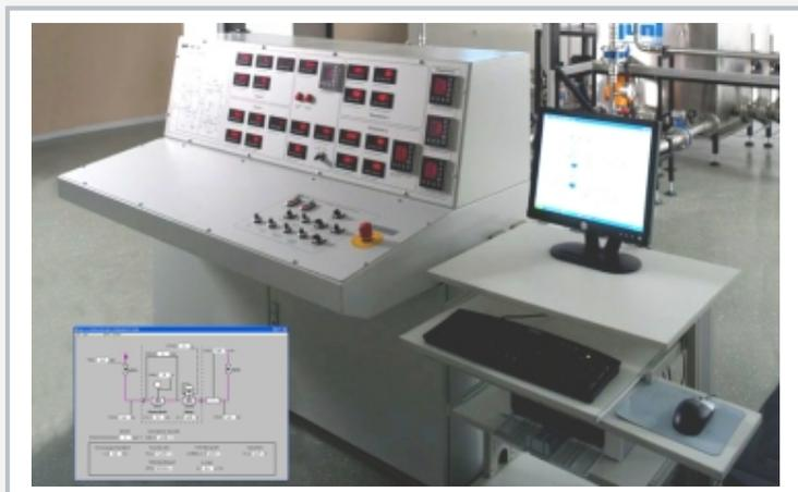
La estación de mando consta de consola de mando y adquisición de datos para el registro y evaluación cómodos de los ensayos
