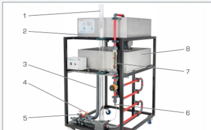
1 chimenea de equilibrio, 2 depósito A con vertedero ajustable, 3 línea de rebose, 4 válvula en tubería de desagüe, 5 válvula de compuerta para la creación de golpes de ariete, 6 toma de agua, 7 caudalímetro, 8 depósito B con reboso
