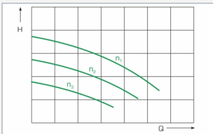
Características de la bomba para diferentes números de revoluciones H altura de elevación, Q caudal, n número de revoluciones
