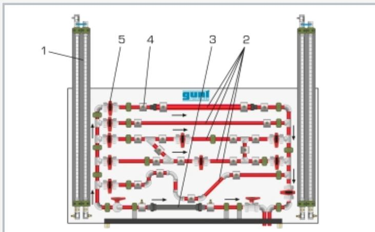
1 2 tubos manométricos, 2 secciones de tubo diversos, 3 sección de tubo para robinetería/dispositivos deprimógenos intercambiables, 4 cámara anular, 5 grifo de bola para cerrar la sección de tubo
