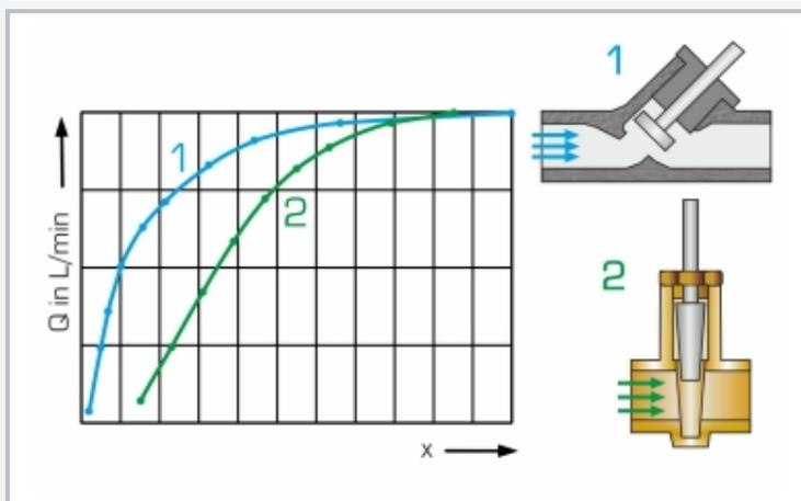
Características de las aberturas de la robinetería de cierre: Q caudal, x apertura, 1 válvula de asiento inclinado, 2 válvula de compuerta
