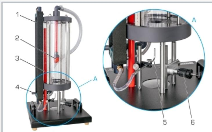
1 colador de alimentación, 2 toma de agua, 3 rebosadero, 4 dos tubos manométricos, 5 tubo de Pitot, 6 instrumento de medición para diámetro del chorro
