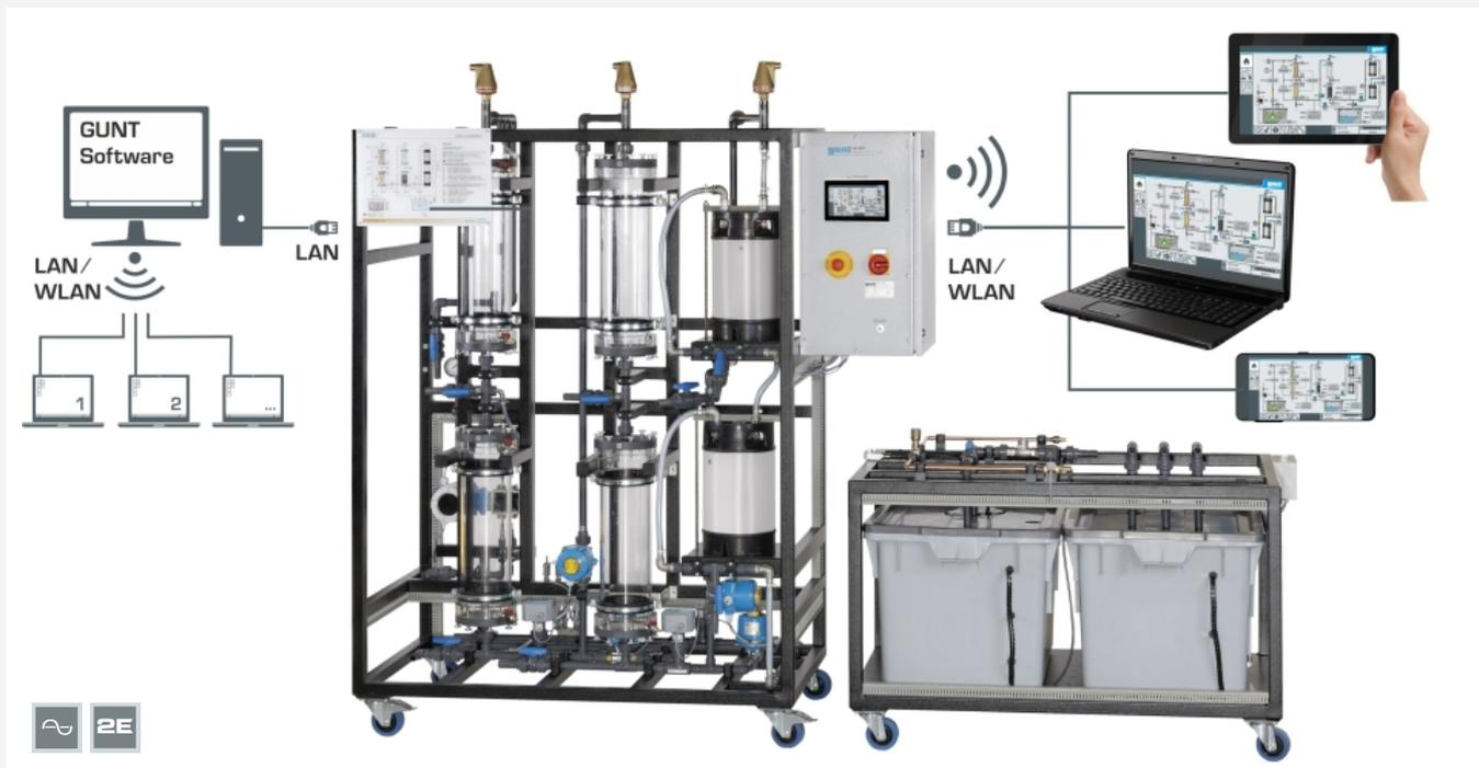
La ilustración muestra un aparato similar: banco de ensayos (izquierda) y unidad de alimentación (derecha), "screen mirroring" es posible con diferentes dispositivos finales
