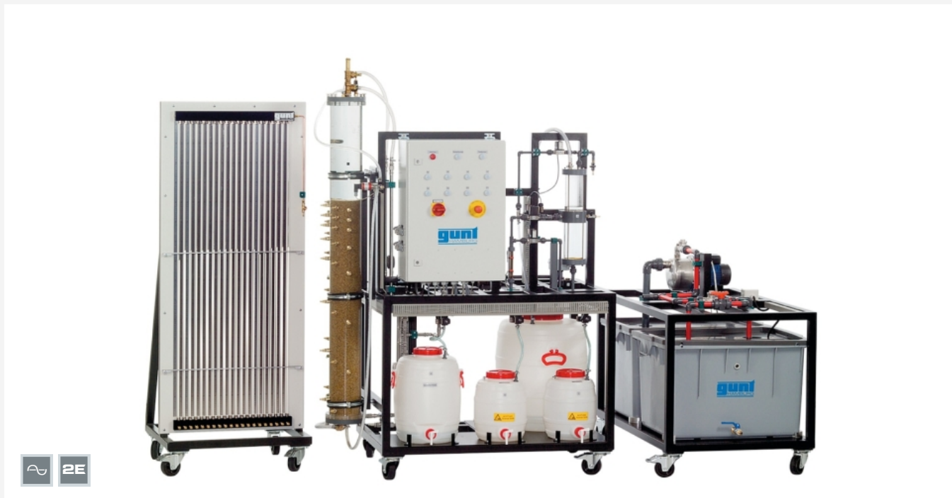
La ilustración muestra, desde la izquierda: panel de manómetro, banco de ensayos, unidad de alimentación
