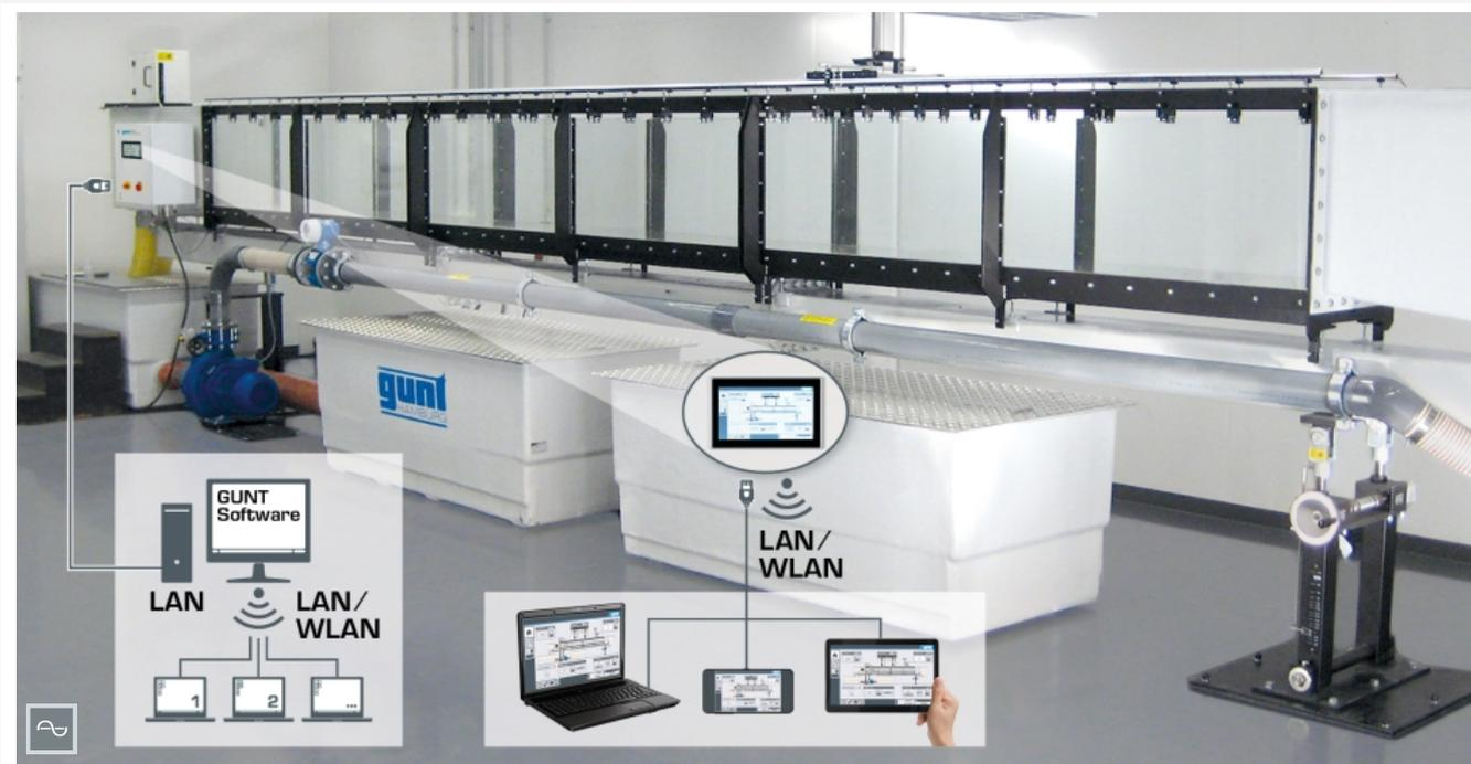
HM 162 (sección de ensayo 7,5m) con el generador de olas HM 162.41 y el indicador del nivel de agua HM 162.52, "screen mirroring" es posible con diferentes dispositivos finales
