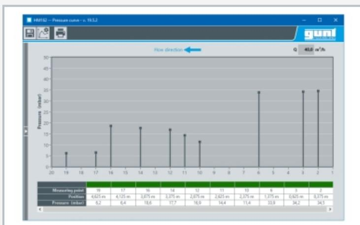
Captura de pantalla del software: el montaje experimental con dos estructuras de control (compuerta en el punto de medición 17, vertedero en los puntos de medición 2, 3 y 6)
