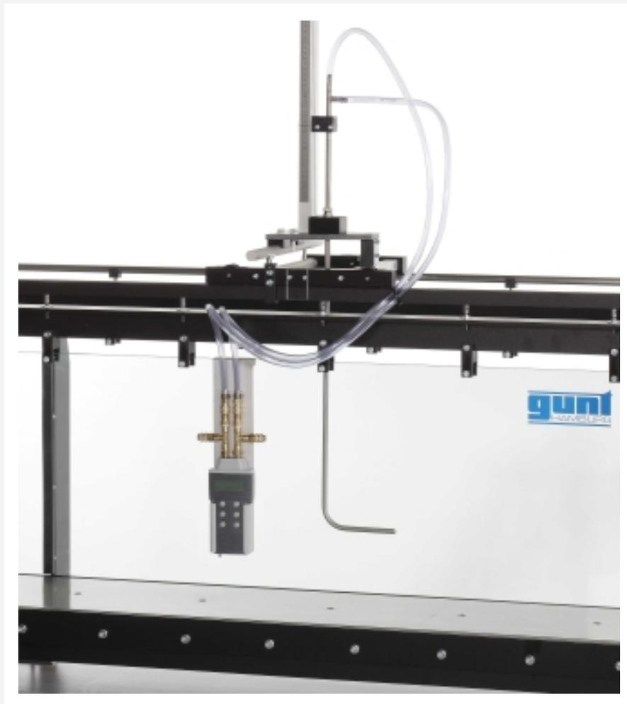
La ilustración muestra el HM 162.50 junto con el portainstrumentos HM 162.59
