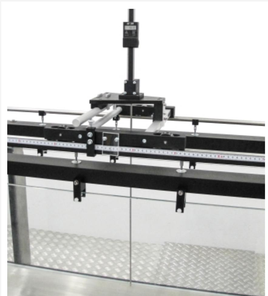
La ilustración muestra el HM 162.91, indicación digital incluida, junto con el portainstrumentos HM 162.59.
