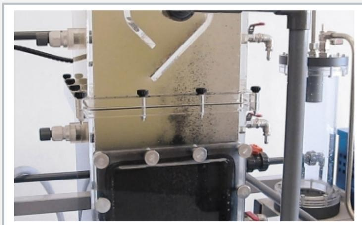
Reactor UASB en el modo de pruebas
