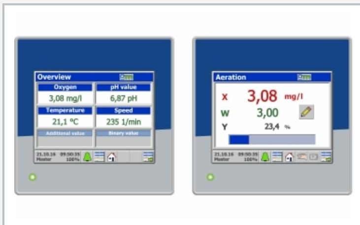
Regulador de proceso digital indicación de las magnitudes del proceso (izquierda), interfaz de usuario para la regulación de la concentración de oxígeno (derecha)
