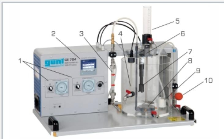
1 elementos de mando para el compresor y el mecanismo de agitación, 2 regulador de proceso, 3 caudalímetro (aire), 4 sensor de pH, 5 dosificador, 6 mecanismo de agitación, 7 absorbente de oxígeno, 8 dispositivo de aeración, 9 flotador para salida de agua clarificada, 10 balón de aspiración para salida de agua clarificada
