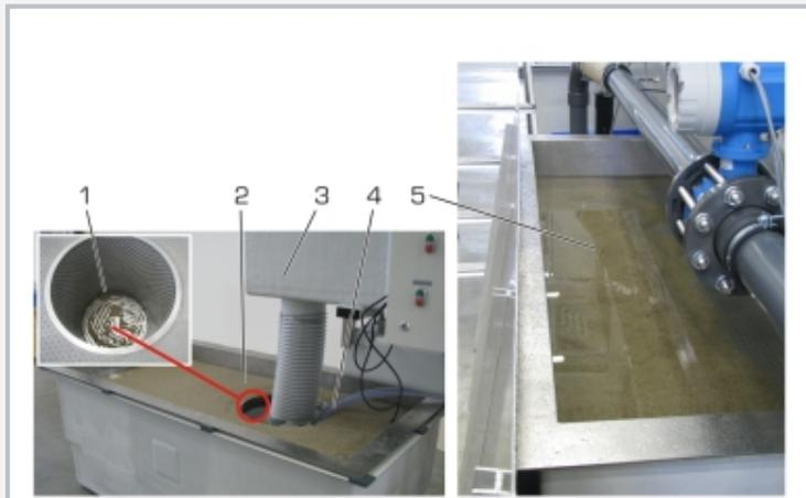
1 cesta de tamiz (bomba no representada), 2 sedimentos, 3 elemento de salida de HM 163, 4 sistema de tuberías para el transporte de la mezcla de agua y sedimentos, 5 tamiz para la eliminación de sedimentos en el segundo depósito de agua
