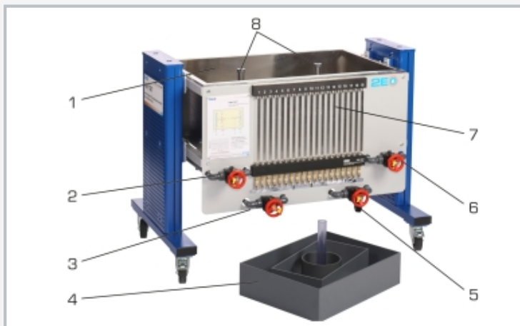
1 depósito, 2 entrada de agua, 3 salida de agua, 4 modelos, 5 salida de agua, 6 entrada de agua, 7 tubos manométricos, 8 salida de agua a través de tubo con ranura (pozo)
