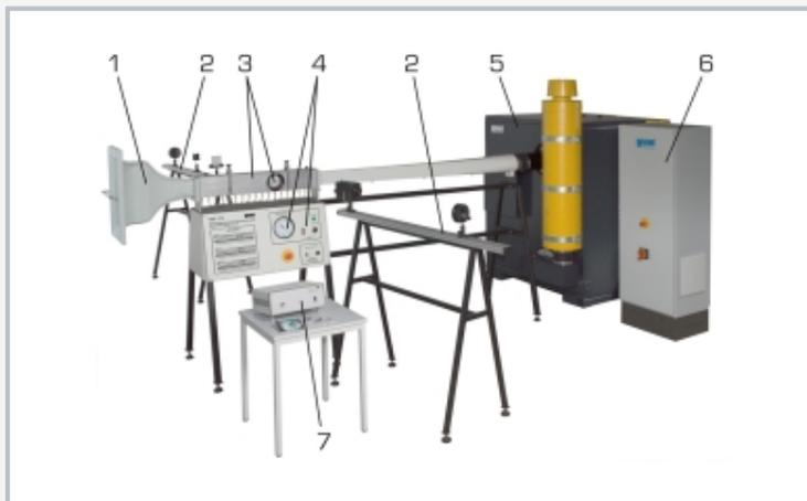
1 túnel de viento supersónico, entrada de aire, 2 óptica de Schlieren (de dos piezas), 3 sección de medida con dos mirillas, 4 pupitre de mando con manómetro, 5 soplante, 6 armario de distribución, 7 adquisición de datos para presiones
