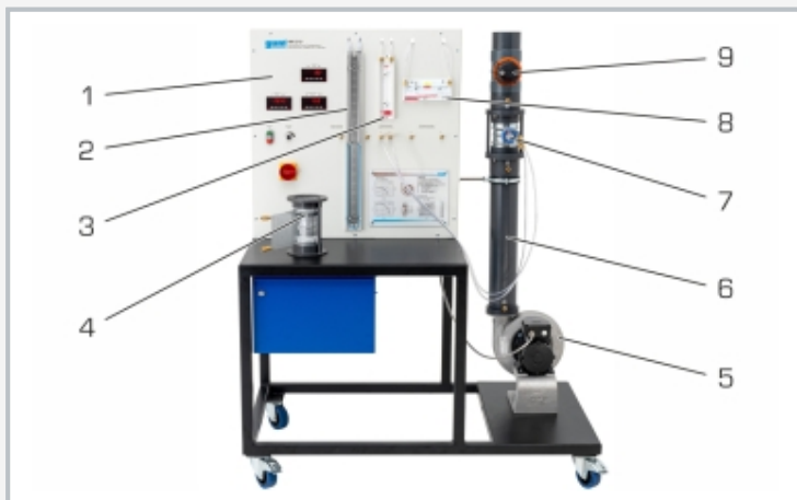
1 armario de distribución con elementos de indicación, 2 manómetro de tubo en U, 3 tubo manométrico, 4 tubo de Venturi, 5 soplante radial con conducto de aspiración, 6 sección de tubo, 7 diafragma de iris, 8 manómetro de tubo inclinado, 9 válvula de mariposa
