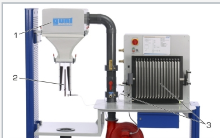
Montaje experimental: 1 HM 225, 2 HM 225.02, 3 tubos manométricos (HM 225) con conexión a HM 225.02
