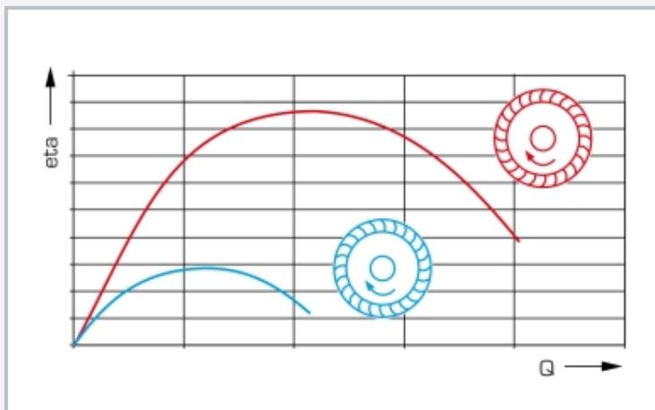
Comparación de rendimientos; rojo: rotor con álabes curvados hacia adelante, azul: rotor con álabes curvados hacia atrás;  $\eta$  rendimiento,  $Q$  caudal
