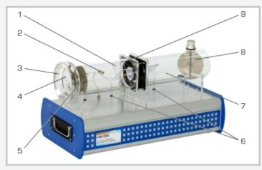
1 chapas directrices para la conducción del flujo, 2 punto de medición de la temperatura, 3 tobera de entrada en el tubo de aspiración, 4 punto de medición de la presión (para la determinación del caudal), 5 rectificador de flujo, 6 puntos de medición para la presión, 7 tubo de presión, 8 válvula de mariposa, 9 soplante axial
