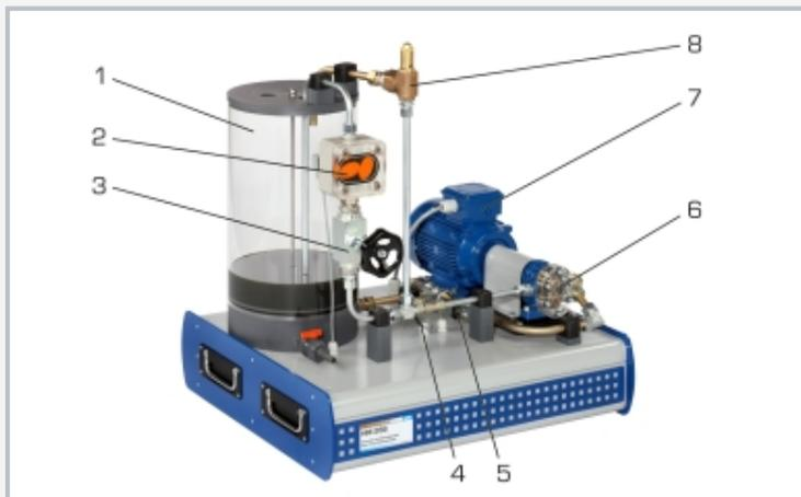
1 depósito, 2 sensor de caudal (contador de ruedas ovaladas), 3 válvula de aguja, 4 sensor de presión de la salida, 5 sensor de presión de la entrada, 6 bomba de engranajes, 7 accionamiento, 8 válvula de rebose para ajustar de altura de elevación
