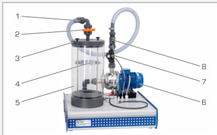
1 toma de agua, 2 válvula de estrangulación para ensayos con bomba, 3 tapa del depósito, 4 placa amortiguadora, 5 depósito de agua, 6 bomba con motor, 7 sensor de presión, 8 sensor de caudal
