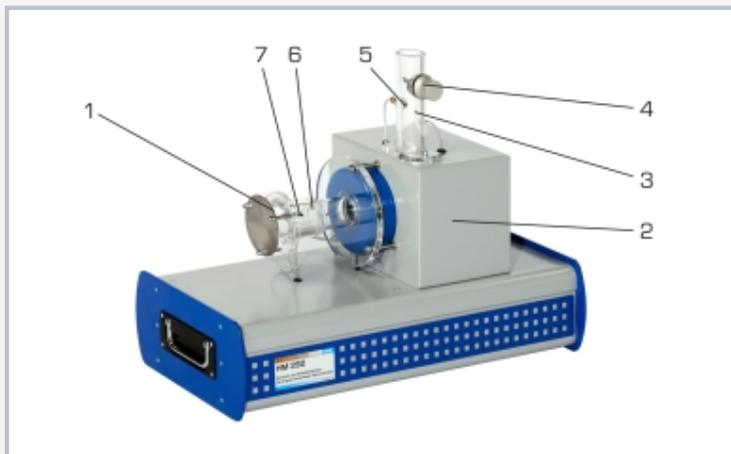
1 entrada de aire con placa protectora, 2 compresores radiales de dos etapas con motor de accionamiento, 3 tubo de presión, 4 válvula de mariposa, 5 sensor de temperatura, 6 tubo de aspiración, 7 sensor de presión
