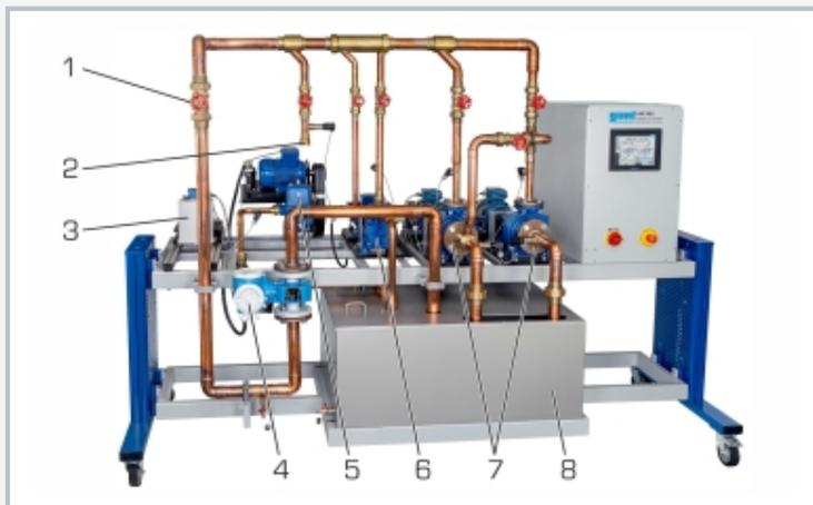
1 válvula de estrangulación (a la salida), 2 conexión para bomba adicional, 3 motor para bomba de adicional, 4 sensor de caudal, 5 bomba de émbolo, 6 bomba de canal lateral, 7 bomba centrífuga, 8 depósito
