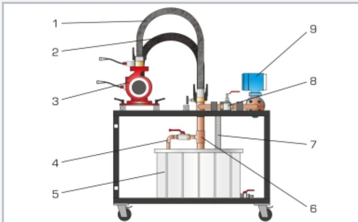
1 salida, 2 entrada, 3 accesorio: bomba (HM 365.11 - HM 365.19), 4 tubería de vaciado, 5 depósito de reserva, 6 tubo de aspiración, 7 retorno, 8 válvula de estrangulación, 9 caudalímetro
