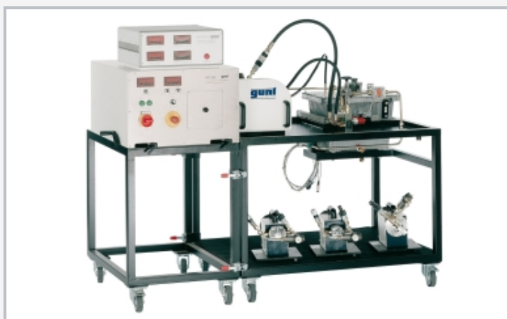
Montaje experimental funcional: unidad de accionamiento HM 365 (izquierda), HM 365.20 con la bomba que se va a estudiar (derecha)
