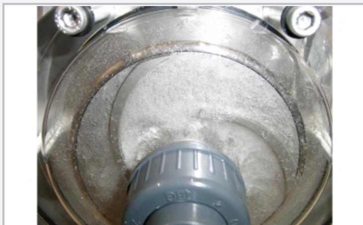
Formación de burbujas de vapor por cavitación en el rodete de la bomba
