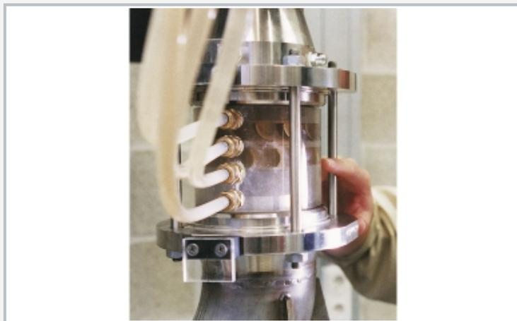
La ilustración muestra los efectos de cavitación en el área de trabajo de la turbomáquina axial
