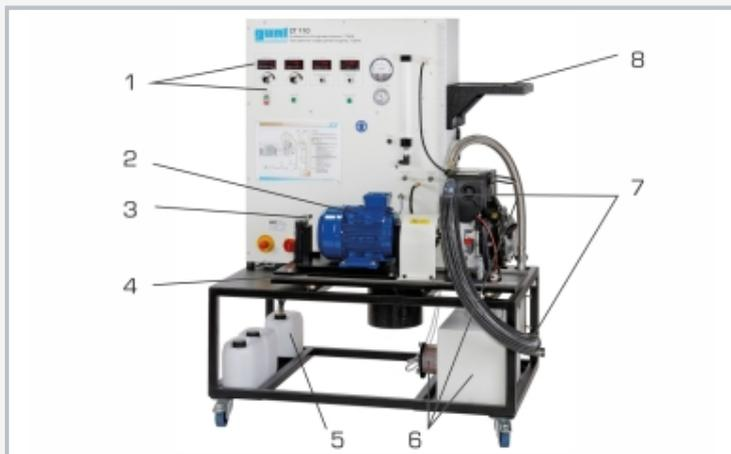
1 elementos de indicación y mando, 2 motor asíncrono, 3 transductor de fuerza (par), 4 fundamento, 5 depósito de combustible con bomba, 6 depósito de estabilización con filtro de aire y manguera de aire, 7 conexión de gases de escape, 8 bandeja, p. ej., para CT 100.13
