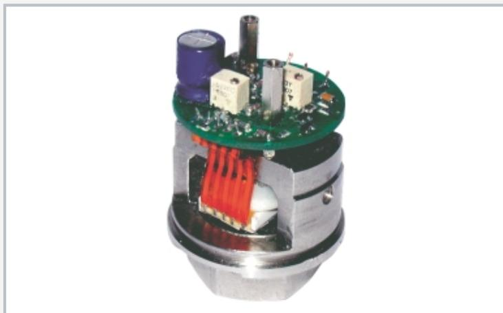
Estructura interna de un sensor de presión electrónico
