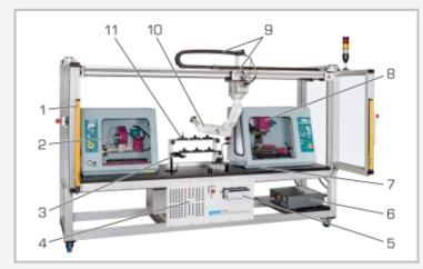
1 dispositivo de seguridad (barrera fotoeléctrica), 2 torno, 3 almacén, 4 tablero de conexiones, 5 PLC, 6 unidad de control del robot, 7 estación de inspección, 8 fresadora, 9 dispositivo de desplazamiento, 10 robot, 11 depósito de piezas acabadas
