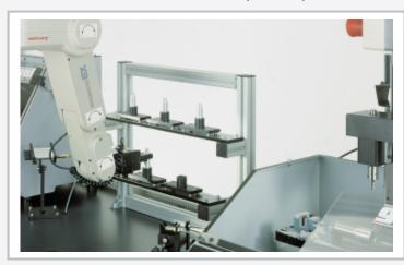
La ilustración muestra el robot durante la deposición de una pieza mecanizada en una pale ta del depósito de piezas acabadas
