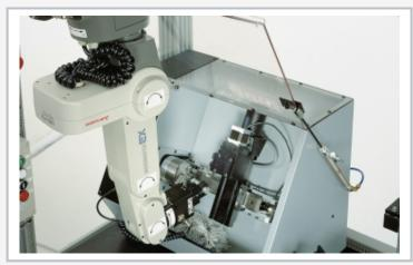
La ilustración muestra el robot durante la toma de una pieza a trabajar del torno
