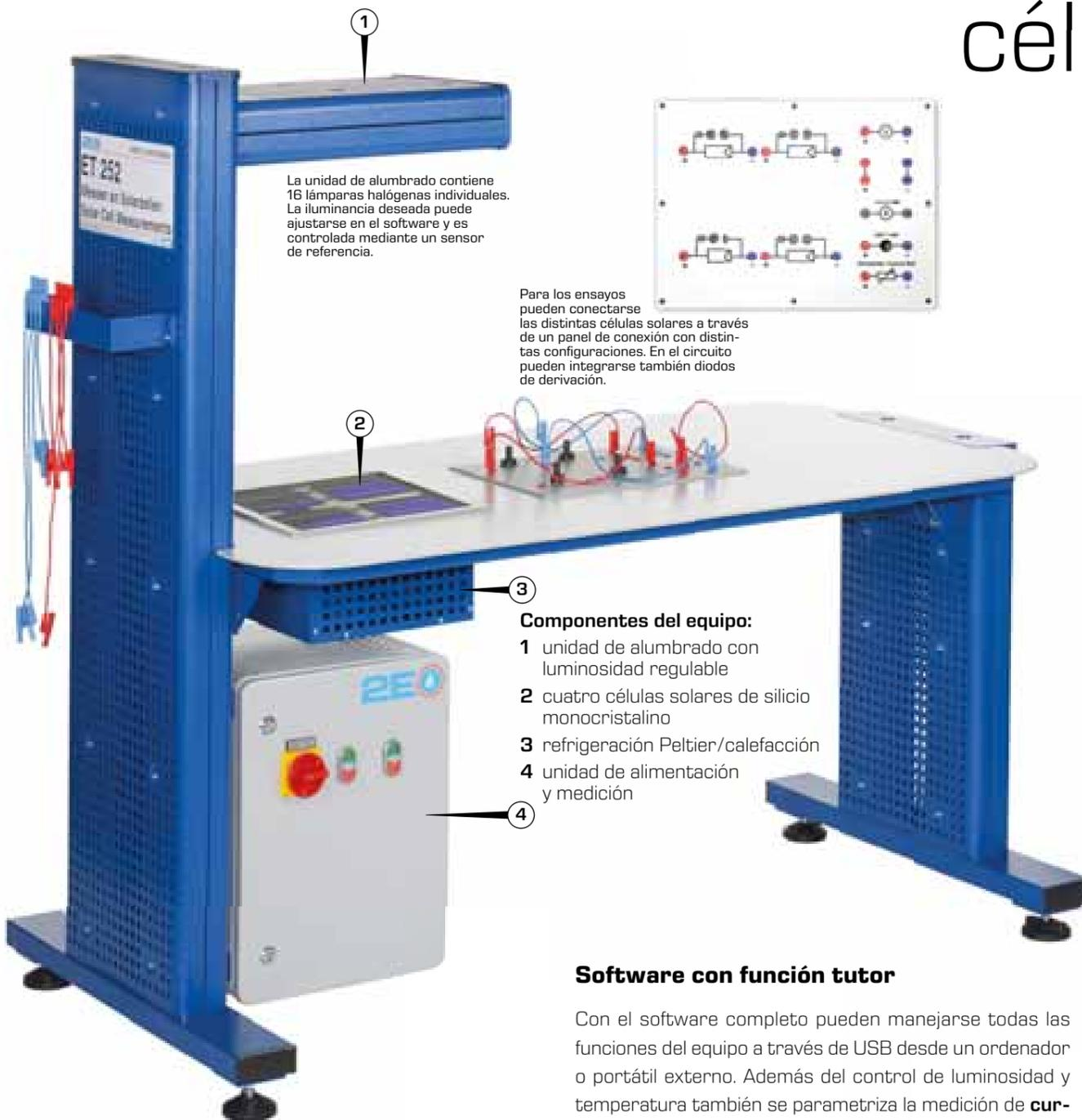
1 La unidad de alumbrado contiene 16 lámparas halógenas individuales. La iluminancia deseada puede ajustarse en el software y es controlada mediante un sensor de referencia.
