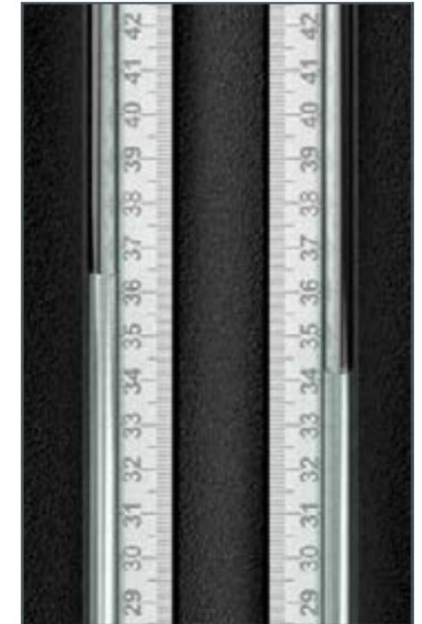
El manómetro de tubos permite determinar pérdidas de carga bajas con un alto grado de precisión.
