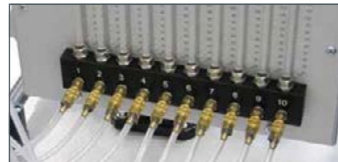
Conexiones en el panel de manómetros para medir la presión en el lecho filtrante
