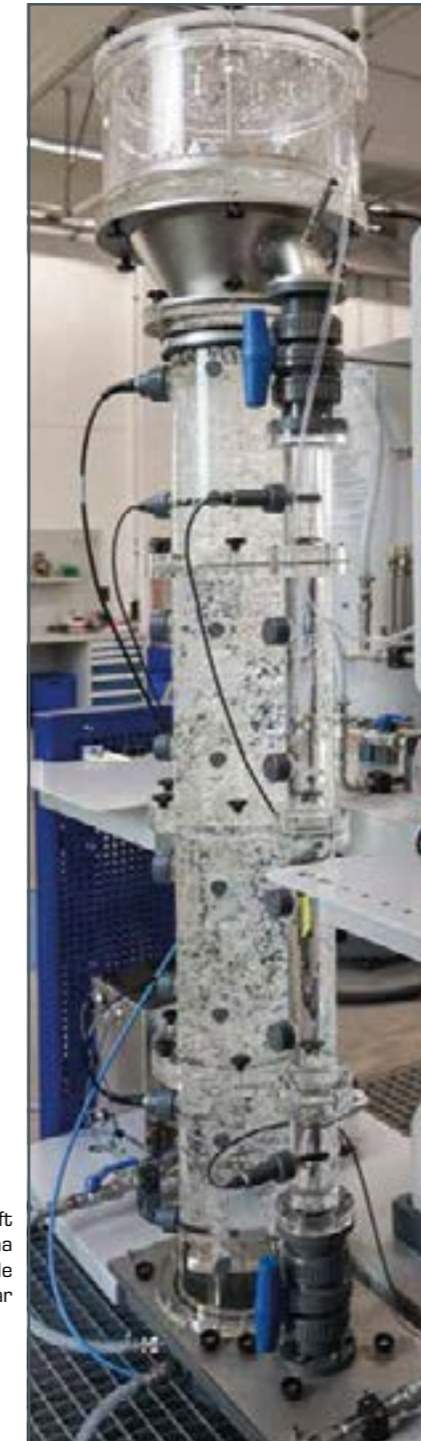
Varios distribuidores para la aeración del reactor
