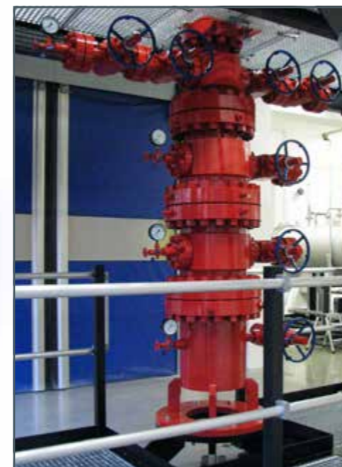
Boca de pozo
