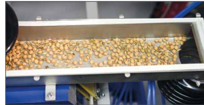
CE 275 durante el funcionamiento de prueba: La canaleta vibratoria alimenta continuamente la mezcla a separar de espelta y huesos de cereza al separador de pliegues.
