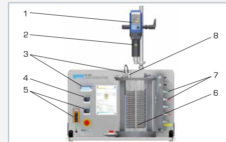
1 agitador, 2 medición del par, 3 medición de la conductividad eléctrica, 4 ajuste de la temperatura, 5 ajuste del caudal para el gas, 6 serpentín, 7 conexiones para agua caliente, agua fría y gas, 8 conexiones libres para otros instrumentos de medición
