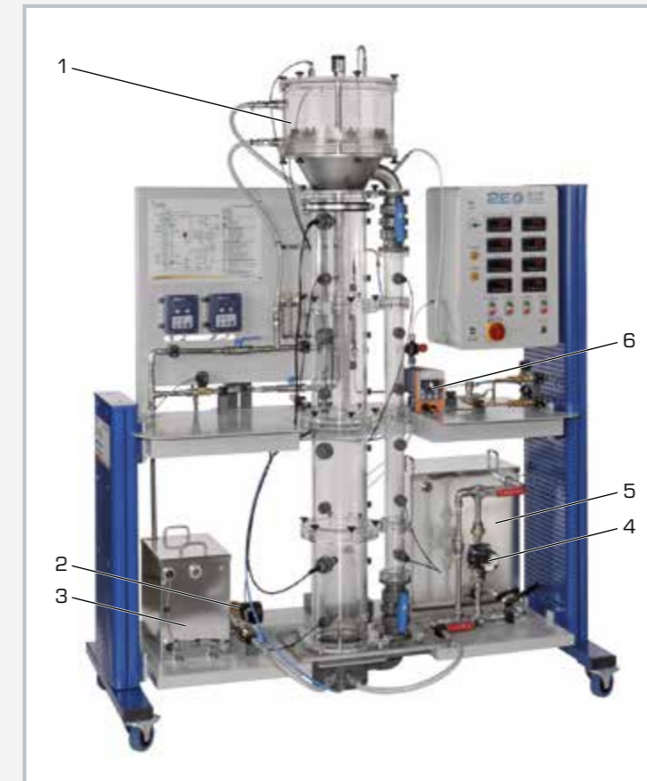
1 reactor airlift con circulación externa, 2 bomba de alimentación, 3 depósito de alimentación, 4 bomba de circulación, 5 depósito de almacenamiento, 6 bomba dosificadora
