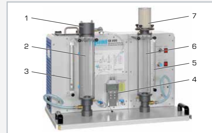
1 rebosadero, 2 depósito para agua, 3 rotámetro para agua, 4 instrumento de medida manual pérdida de carga, 5 rotámetro para aire, 6 depósito para aire, 7 filtro
