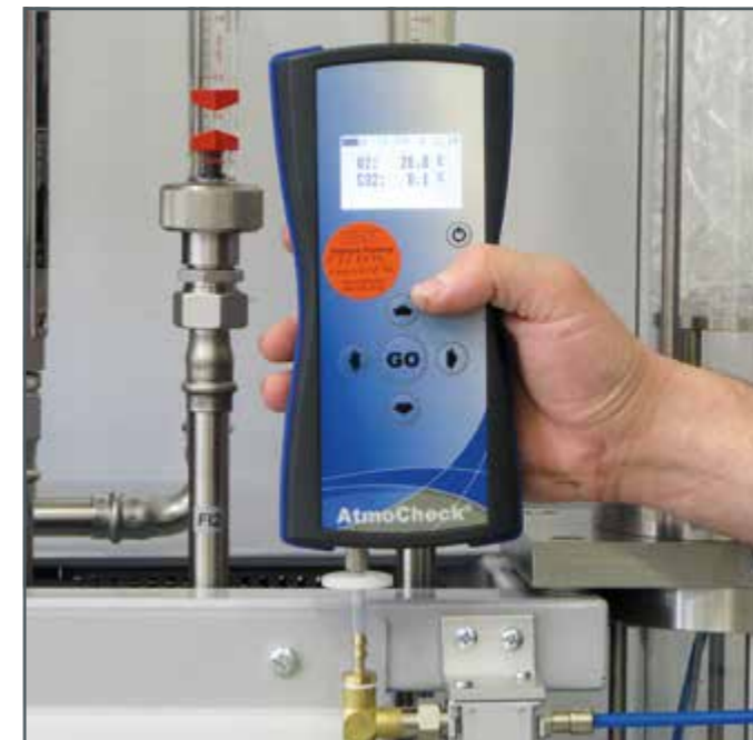
Equipo de análisis de gas para determinar el contenido de oxígeno y de dióxido de carbono.
