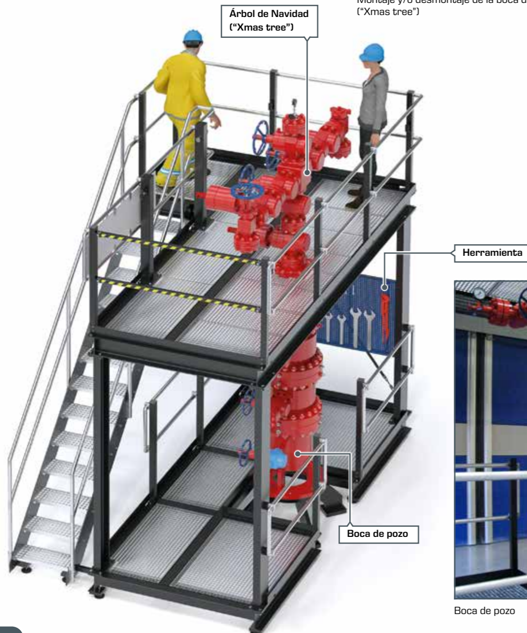
Montaje y/o desmontaje de la boca del pozo y del árbol de Navidad ("Xmas tree")
