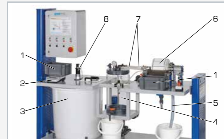
1 depósito colector de la torta filtrante, 2 balanza, 3 depósito de reserva de suspensión, 4 depósito a vacío para filtrado, 5 rebosadero/salida, 6 filtro de tambor, 7 conexión de vacío, 8 agitador
