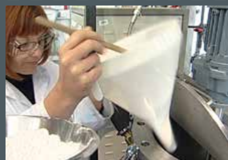
Adición de las materias primas al depósito de maceración
