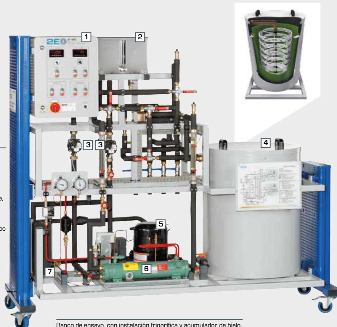
Banco de ensayo con instalación frigorífica y acumulador de hielo
