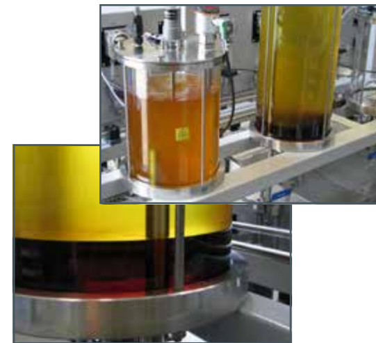
Los depósitos transparentes permiten la observación continua de las reacciones y los procesos de separación.
